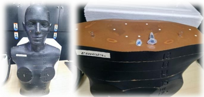
Fig. 1. Fantoma antropomórfico utilizado para simulação de exposição à radiação gama. (A) Vista frontal do fantoma do tipo feminino, utilizado como suporte para acomodação de dosímetros e amostras de sementes de Allium cepa em regiões anatômicas específicas. (B) Vista superior do fantoma com destaque para as sementes de Allium cepa posicionadas sobre o topo da cabeça, simulando uma situação de exposição direta à radiação incidente. A estrutura foi utilizada com o objetivo de avaliar o comportamento das sementes em um cenário simulado de exposição parcial do corpo humano à radiação ionizante.
